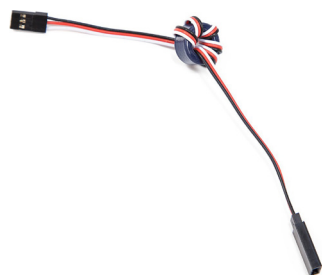
Fotografia 13. Dławik przeznaczony do filtracji zakłóceń
